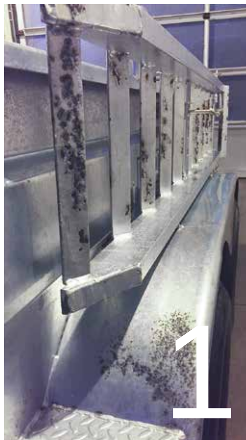
Photo 1 : Exemple de matériel galvanisé exposé aux sels de déglçage avant que la passivation naturelle du zinc ait eue lieu.
